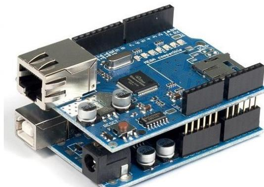
Imagem 2. Placa de Arduino conectada ao Shield Ethernet.
