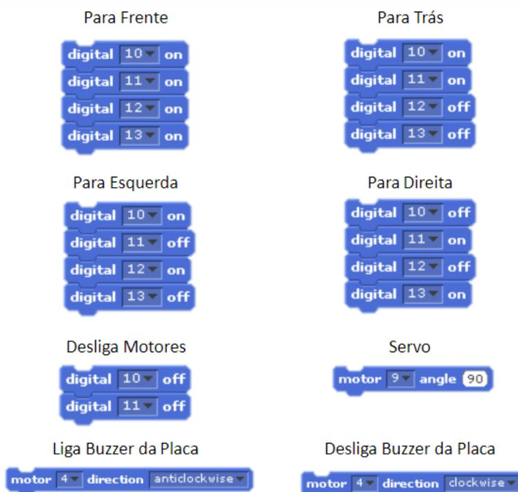
Figura 7: Comandos em blocos indicados para o funcionamento da Ponte-H. Fonte: dos autores.
