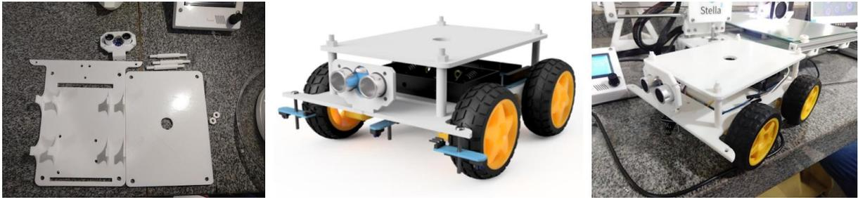
Figura 8: Projeto do protótipo robótico: à esquerda, encontram-se os componentes da estrutura; ao centro, o projeto renderizado do robô; e à direita, o protótipo impresso por tecnologia de impressão 3D.
